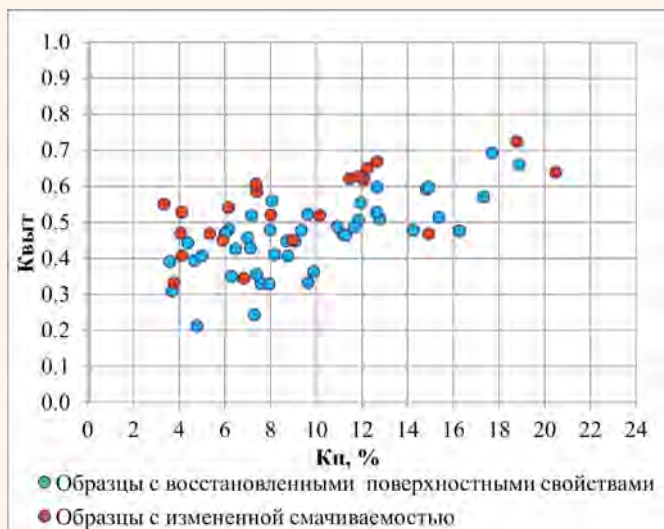
Рис. 3. Сопоставление коэффициента вытеснения нефти водой K_{\text{выт}} и пористости по образцам керна Восточно-Ламбейшорского месторождения
