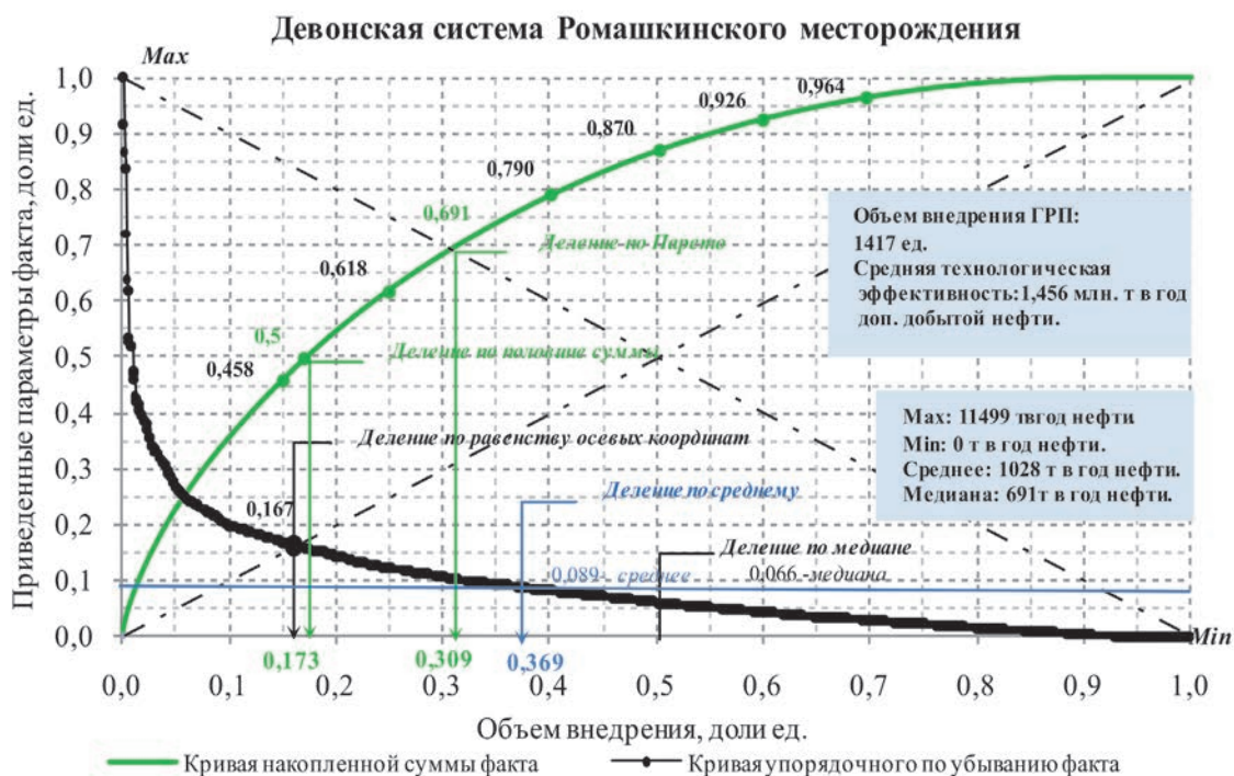
Рис. 5. Характер распределения среднегодовой технологической эффективности ГРП девонской залежи Ромашкинского месторождения ПАО «Татнефть»
